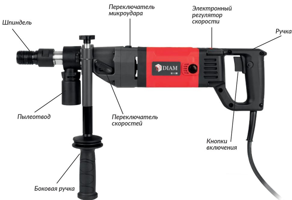
Сверлильная машина ML-130E-НIT предназначена для мокрого или сухого сверления отверстий в бетоне, кирпиче железобетоне и других подобных материалах. Машина оснащена двухскоростным редуктором, электронным плавным регулятором оборотов. Электрический двигатель оснащён функцией мягкий старт и электронной защитой от перегрузки.
